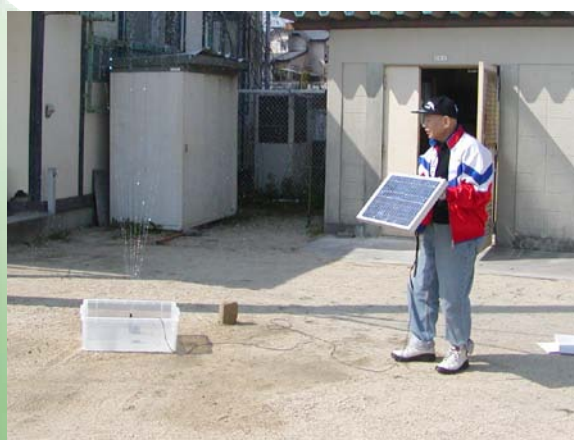
環境学習に使用する太陽光発電の噴水装置
